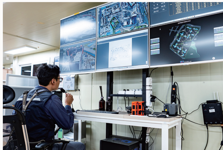
“타워크레인 양중작업 땀 경보를 울려 접근을 차단하고, CCTV 관제 시스템을 통해 현장을 실시간으로 모니터링한다.”
